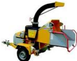
Фиг. 1. Подвижна секачна машина с автономно задвижване Schliesing 200 MX
